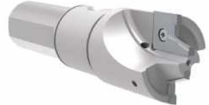
Broca i-Form para operaciones de careado con chaflán del diámetro interno y del externo
