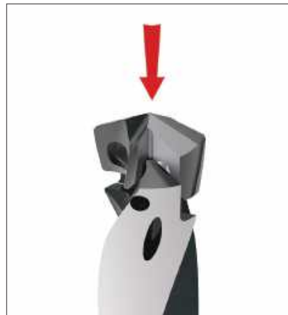
Étape 2 : Faire glisser l'embout dans l'emplacement pour la découpe d'assemblage du porte-outil. L'embout ne doit pas être tournée ou tordu. L'emplacement du porte-outil et le repère sur l'embout assurent une fixation et une répétitivité optimale.
